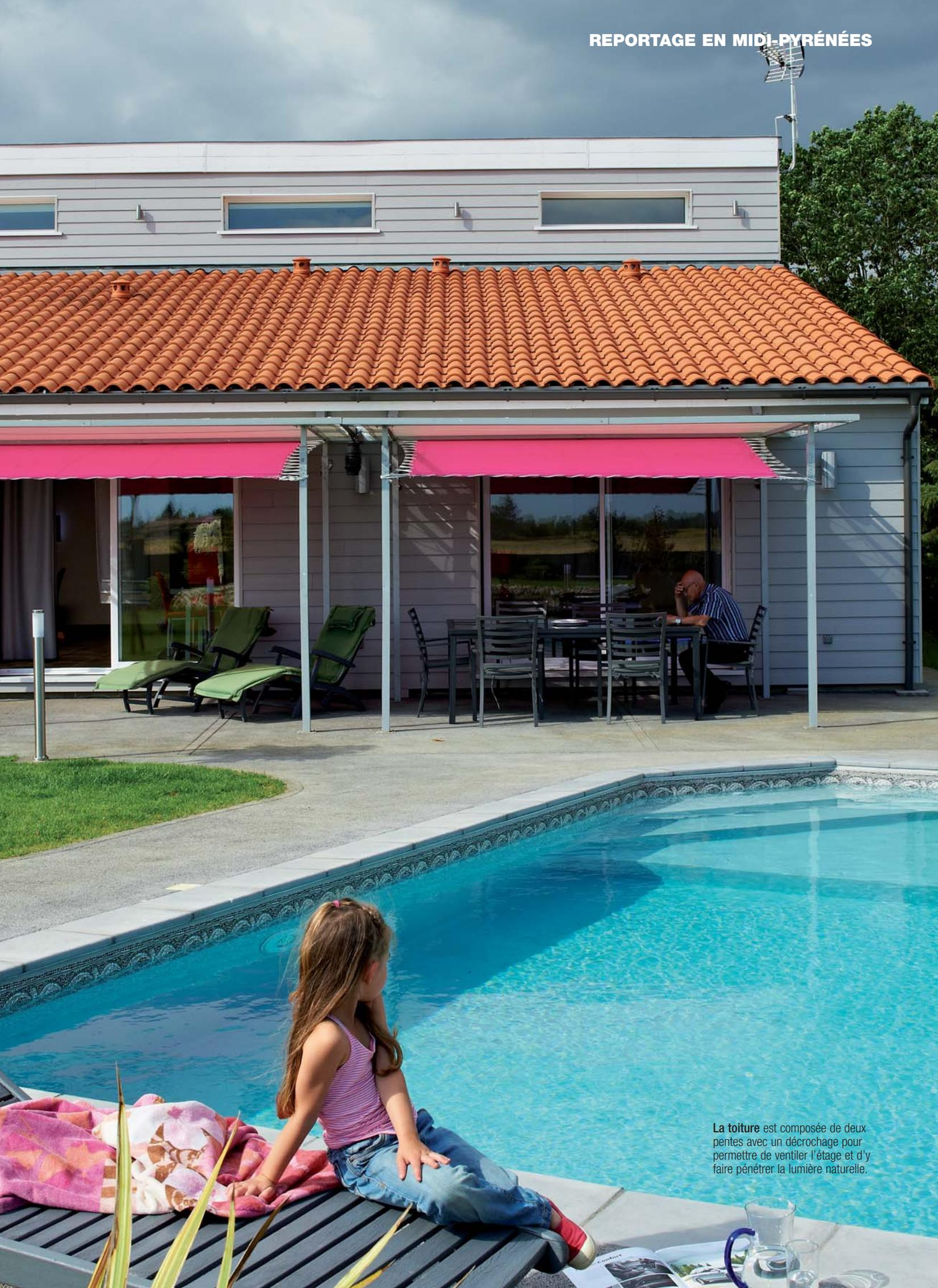
La toiture est composée de deux pentes avec un décrochage pour permettre de ventiler l'étage et d'y faire pénétrer la lumière naturelle.
